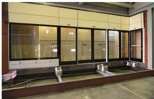
月台門原型機組裝完成
