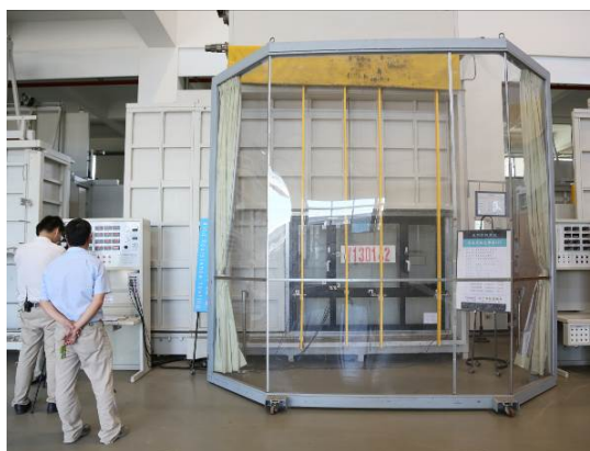
風壓試驗中使用透明耐擊板安全護罩
