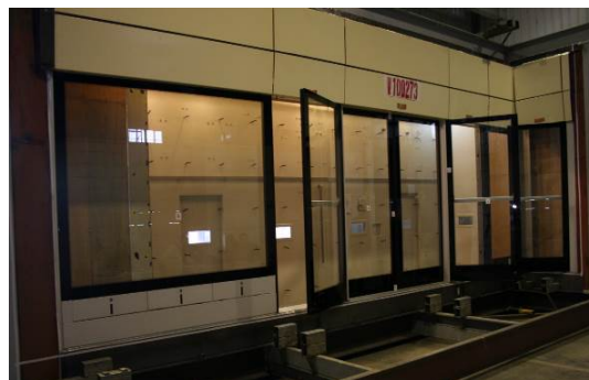
月台門原型機開閉確認
