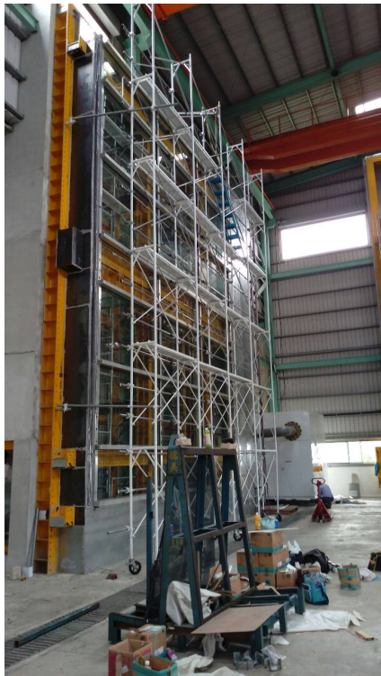
CT-310C 平面帷幕試體組裝中
