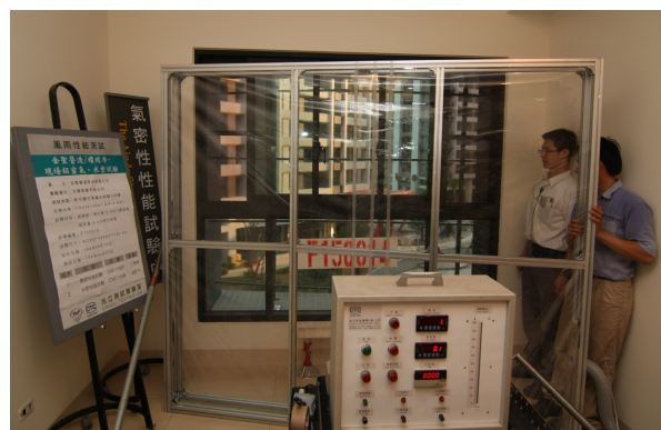
現場氣密預壓後開閉確認中
