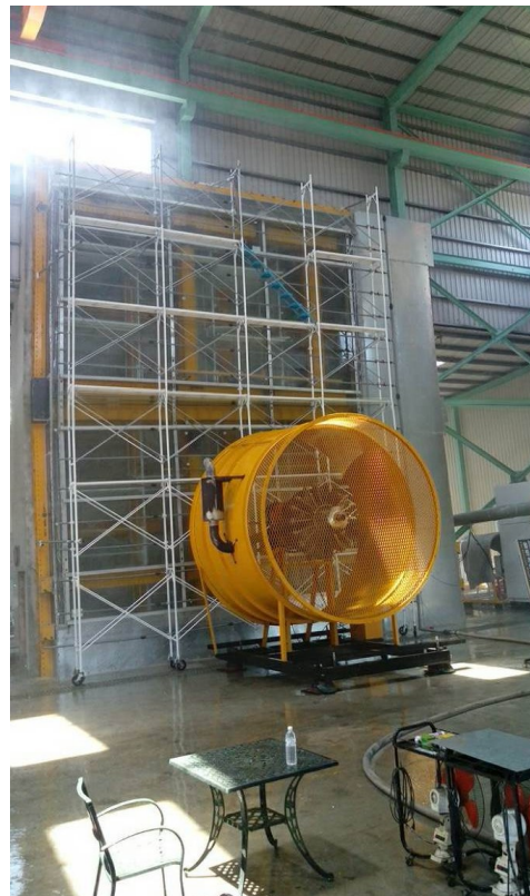
CT-310C 平面帷幕動態水密試驗中
