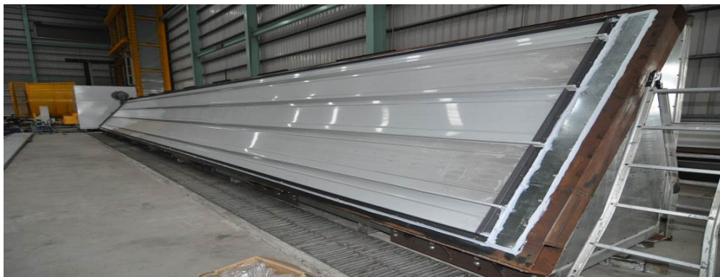
18 m 全尺度金屬屋頂板正負風壓性能試驗
