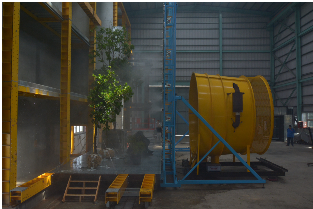
CT-380C 植栽動態水密試驗中
