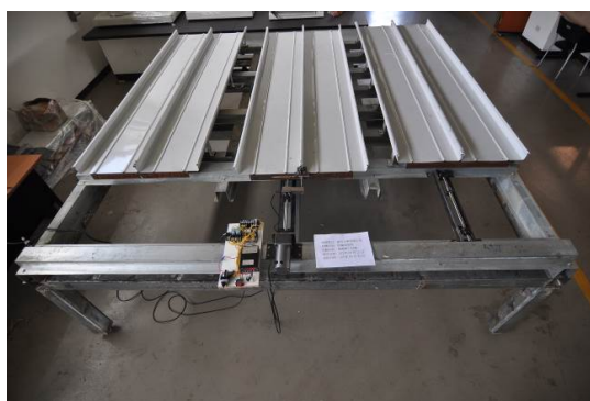
洗窗機扣件拉拔試驗中
