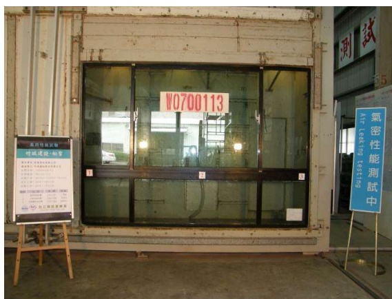
下固定上橫拉鋁窗三性試驗
